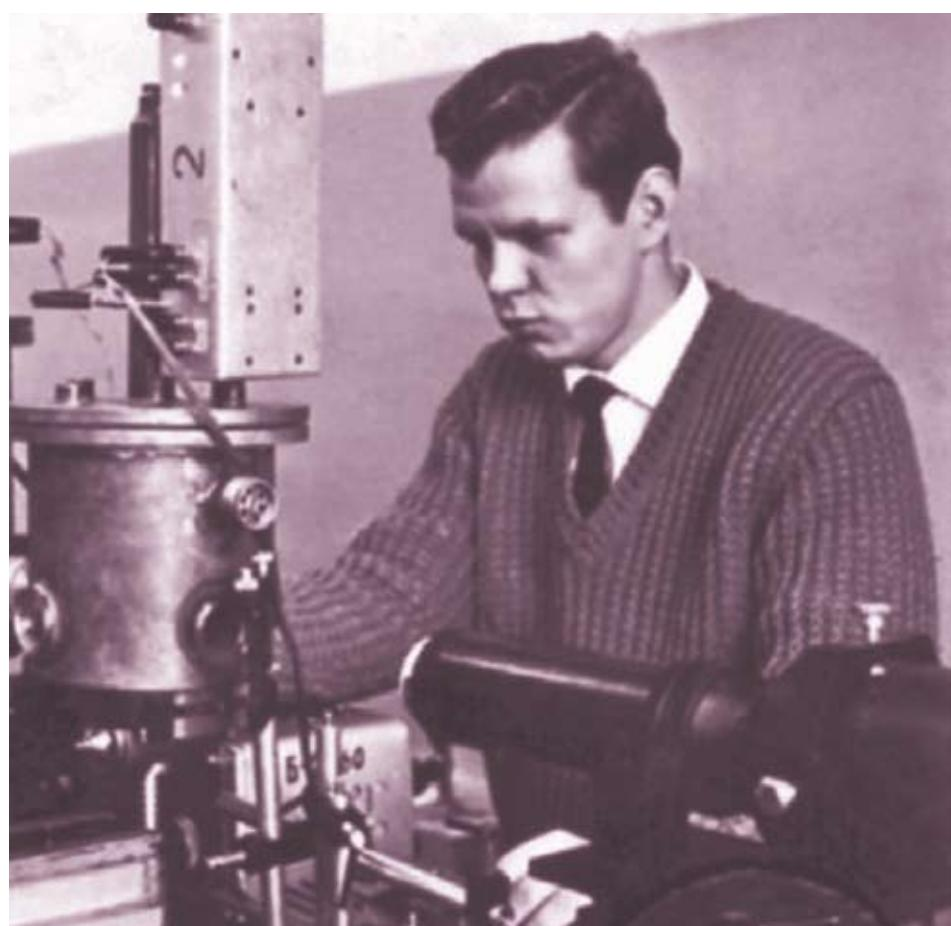
Младший научный сотрудник А. С. Семенов изучает оптические логические элементы на основе полупроводниковых лазеров. 1 декабря 1967 г.
