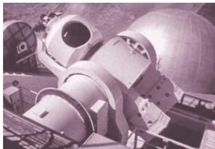
Система наведения комплекса «Терра-3» с лазерным локатором.
